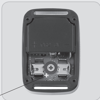
Indicazione della polarità della batteria
